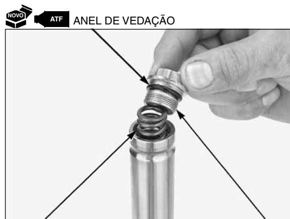
PARAFUSO SUPERIOR DO GARFO
