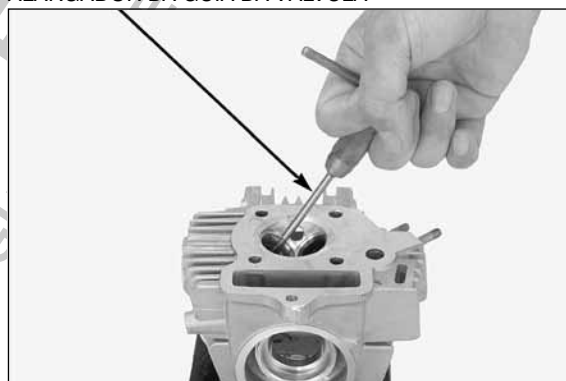
ALARGADOR DA GUIA DA VÁLVULA
