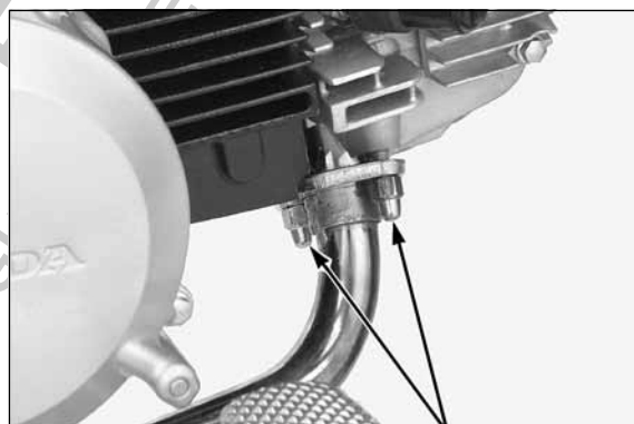
PORCAS DE UNIÃO DO TUBO DE ESCAPAMENTO
