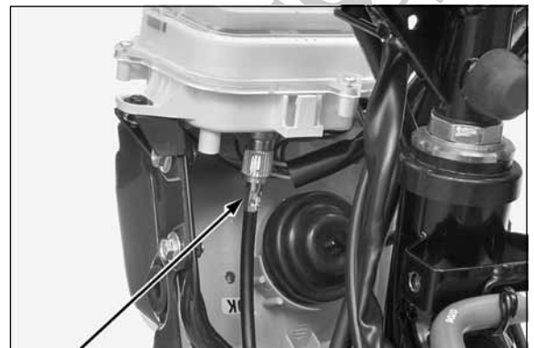
CABO DO VELOCÍMETRO
