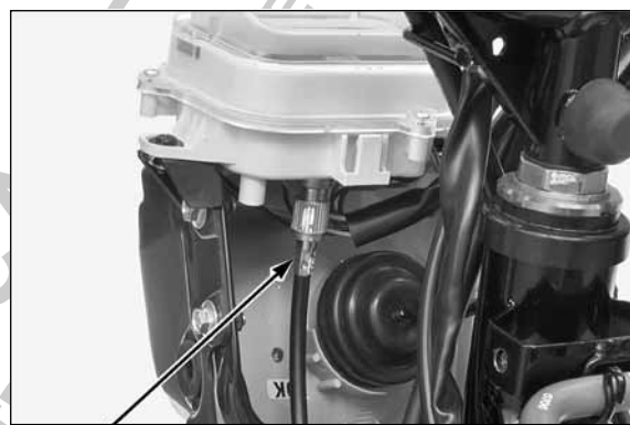
CABO DO VELOCÍMETRO
