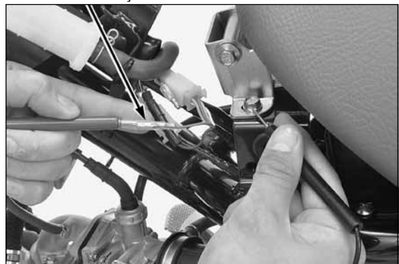
CONECTOR DO FIO DO GERADOR DE PULSOS DA IGNIÇÃO
