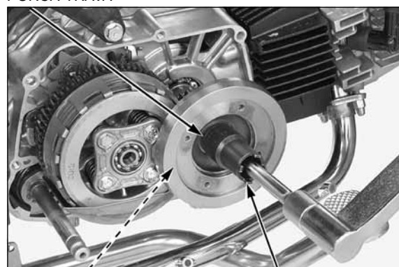
FIXADOR DE ENGRENAGEM
