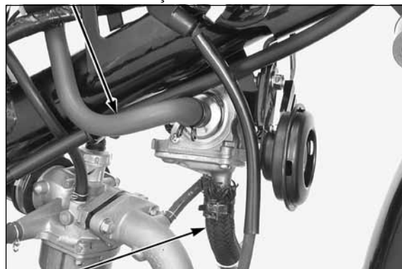
MANGUEIRA DE SUPRIMENTO DE AR
