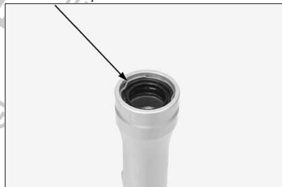
INSTALADOR RETENTOR DE ÓLEO ADAPTADOR ANEL DE RETENÇÃO
