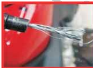
CABO ROMPIDO DEVIDO À MONTAGEM INCORRETA
