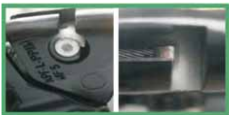
EXTREMIDADE DO CABO POSICIONADA CORRETAMENTE NA ALAVANCA DE EMBREAGEM
