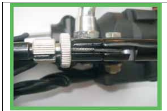
AJUSTADOR E CONTRAPORCA POSICIONADOS INCORRETAMENTE
