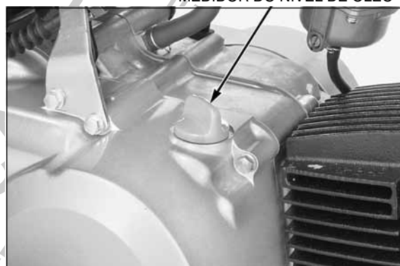
ARRUELA DE VEDAÇÃO PARAFUSO DE DRENAGEM MEDIDOR DO NÍVEL DE ÓLEO
