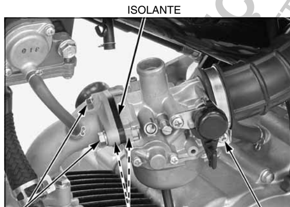
ISOLANTE PARAFUSOS ANÉIS DE VEDAÇÃO PARAFUSO
