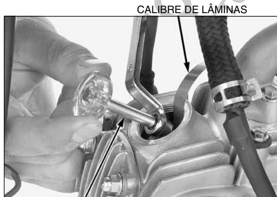
AJUSTADOR DE VÁLVULAS
