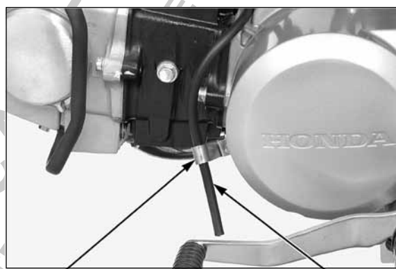
GUIA DA MANGUEIRA MANGUEIRA DE RESPIRO MANGUEIRA DE DRENAGEM
