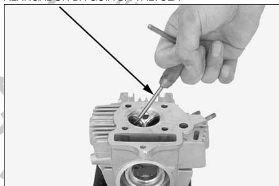
ALARGADOR DA GUIA DA VÁLVULA
