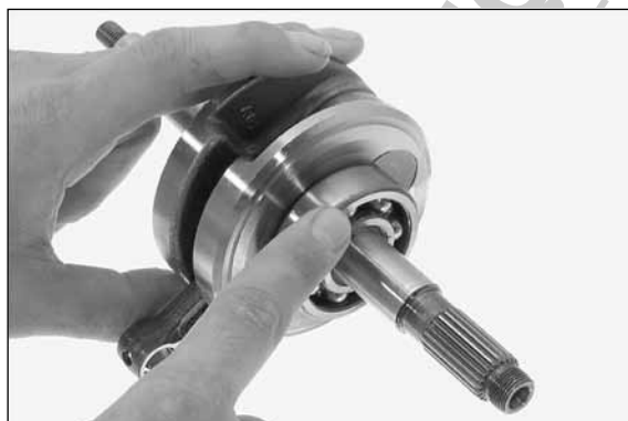
ENGRENAGEM DE SINCRONIZAÇÃO
