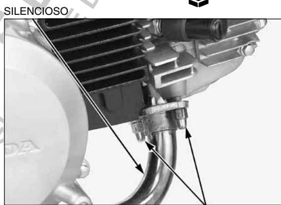
PORCAS DE UNIÃO DO TUBO DE ESCAPAMENTO
