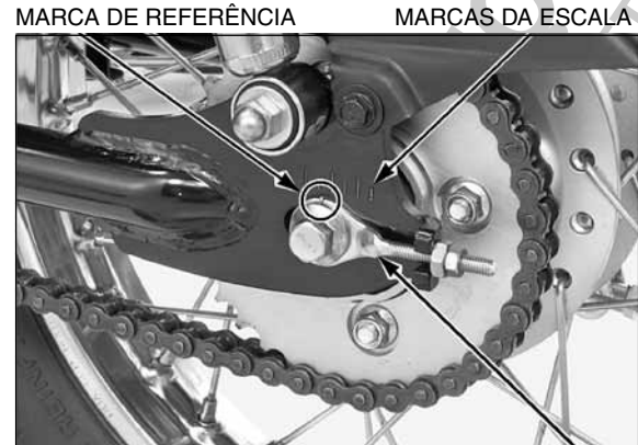
MARCA DE REFERÊNCIA MARCAS DA ESCALA AJUSTADOR
