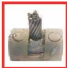
IMAGEM AMPLIADA DO CABO ROMPIDO NA EXTREMIDADE
