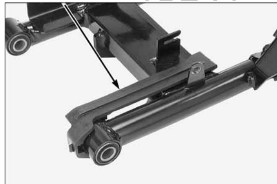
DESLIZADOR DA CORRENTE
