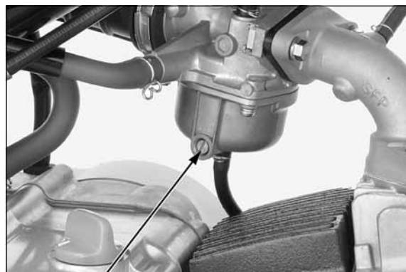
PARAFUSO DE DRENAGEM
