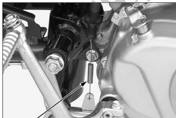
MOLA DO INTERRUPTOR DA LUZ DO FREIO TRASEIRO
