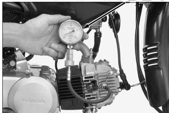
MEDIDOR DE COMPRESSÃO DO CILINDRO
