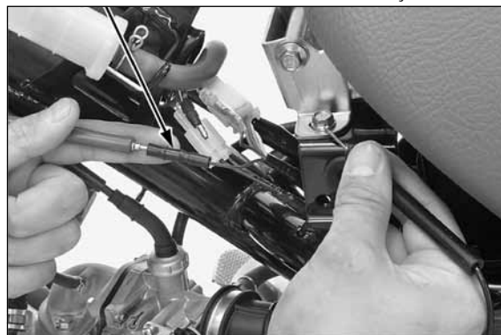
CONECTOR DO FIO DA BOBINA DE EXCITAÇÃO
