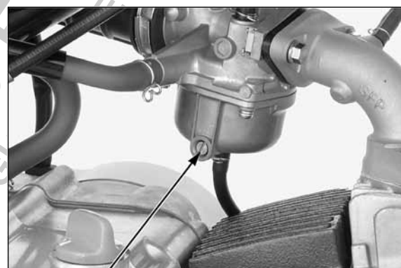
PARAFUSO DE DRENAGEM
